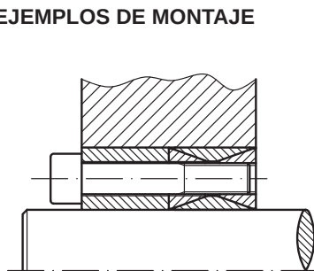
Fijación de un cubo mediante un TEK-200 con anillo centrador especial.
