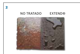
Resultado de un ensayo de 6 meses en niebla salina.
