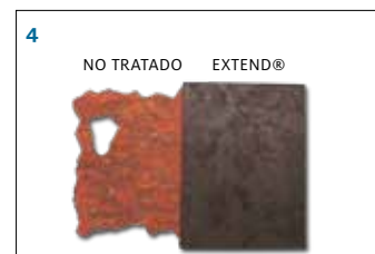
Resultado de una muestra tratada luego de 18 meses en un ambiente con elevada humedad relativa.
