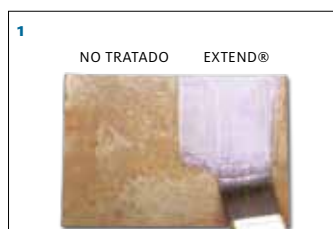
Muestra tratada con Loctite® Extend Rust Treatment en un 50% de su superficie y el resto sin tratar.
