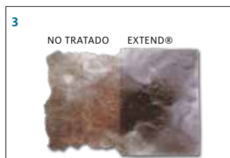
Resultado de una muestra tratada luego de un año en un ambiente con elevada humedad relativa.
